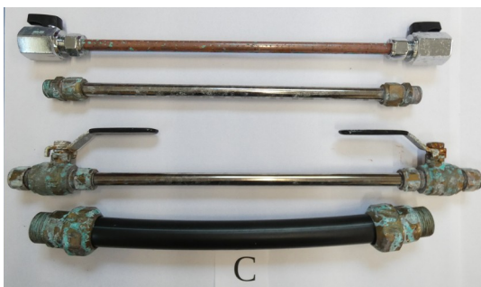
Kuva 10. Näytesarjan C näytteet suolasumuaaltistuksen ja pesun jälkeen
