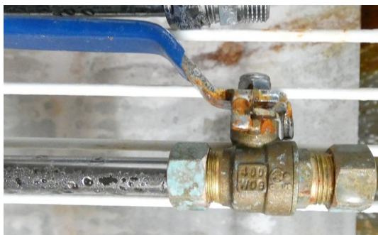
Kuva 7. Korroosio B-sarjan näytteen kahvassa 24 testitunnin jälkeen.
