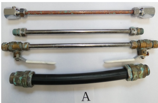
Kuva 8. Näytesarjan A näytteet suolasumuaaltistuksen ja pesun jälkeen
